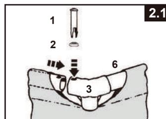
La dernière pièce en T peut être difficile à installer. Pour le faire, vous devez d'abord soulever simultanément la dernière pièce en T et la poutre de plus de 5cm. Insérez maintenant la poutre dans la pièce en T tout en abaissant les pièces dans la bonne position. La poutre glissera alors facilement dans la pièce en T. (Voir schéma 2.2). Assurez vous que la dernière poutre est complètement assemblée avant d'emboîter les pieds.
